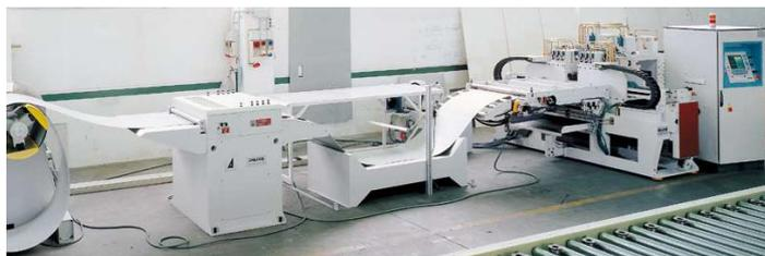
Nr. 2 impianti di punzonatura da nastro, per lamiera sottili, che permette lavorazioni in continuo di particolari di vario genere, specialmente pannellature, ripiani e mantellature.
