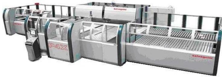
Impianto di pannellatura automatica che permette la piegatura di pannelli in lamiera sottile con elevatissima precisione e ripetibilità dei pezzi.
