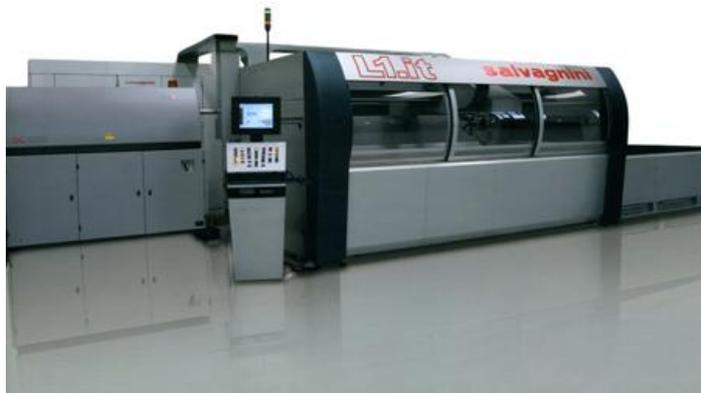
Impianto taglio laser con campo di lavoro 3000x1500mm e capacità di taglio fino a 15mm di spessore.
