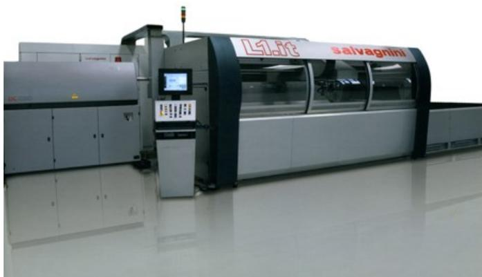
Impianto taglio laser con campo di lavoro 3000x1500mm e capacità di taglio fino a 15mm di spessore.
