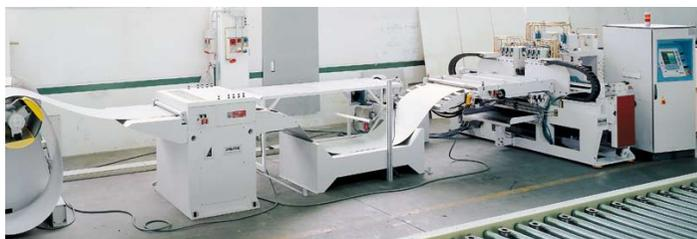
Nr. 2 impianti di punzonatura da nastro, per lamiera sottili, che permette lavorazioni in continuo di particolari di vario genere, specialmente pannellature, ripiani e mantellature.
