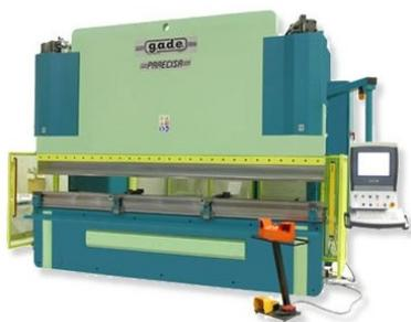
Nr. 5 presso-piegatrici con controllo automatico, di diverse misure e potenze che possono arrivare fino ai 4 metri di lunghezza e 200 Ton di potenza.
